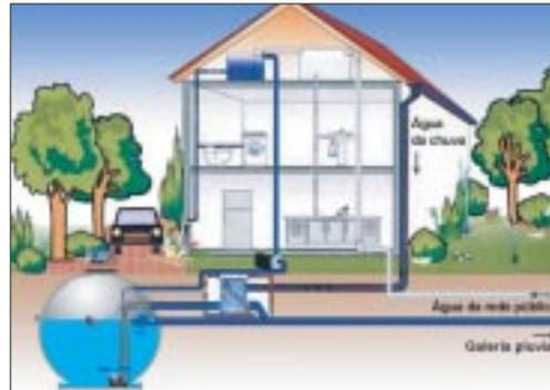
Esquema de Instalação do Sistema de Aproveitamento de Águas Pluviais
